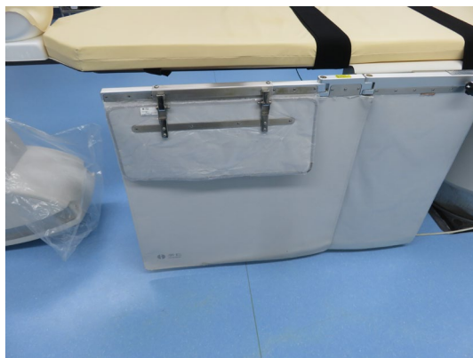
图 3-6 DSA 设备配备床侧铅帘
