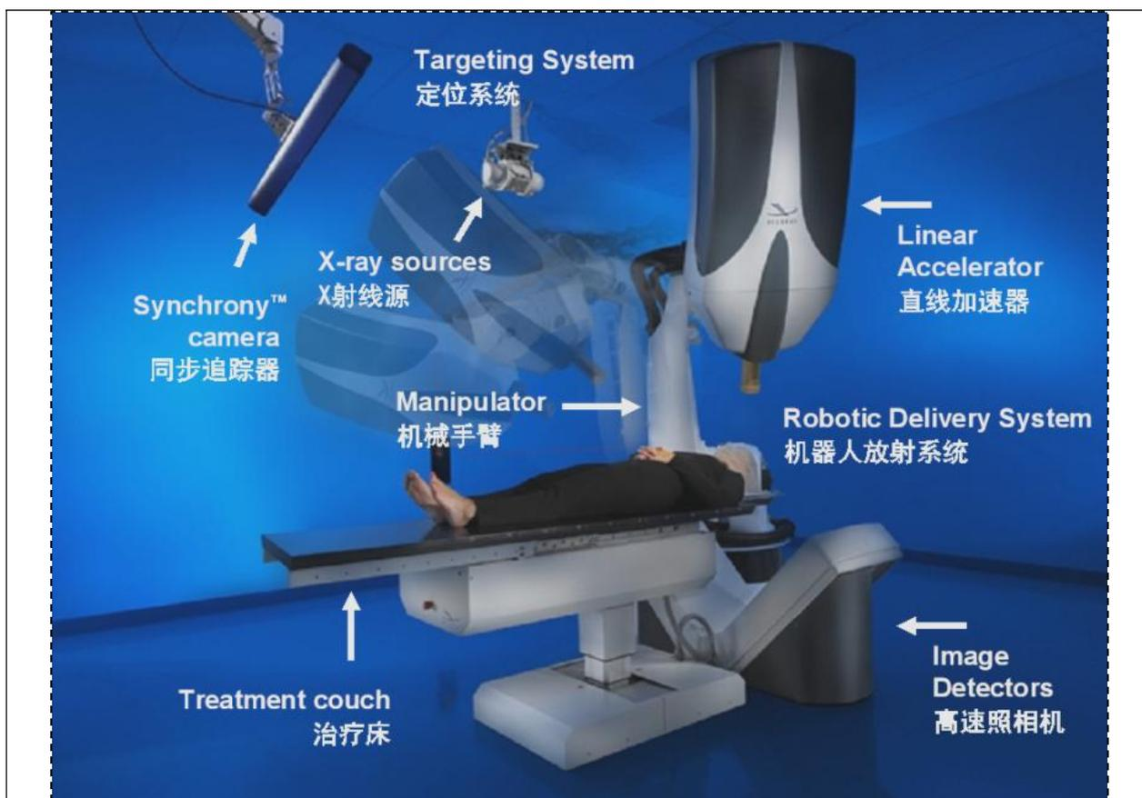
图 2-5 射波刀结构示意图
