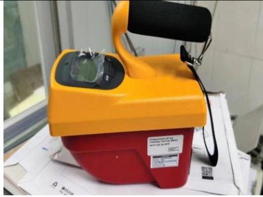
图 3-28 451P 型辐射检测仪
