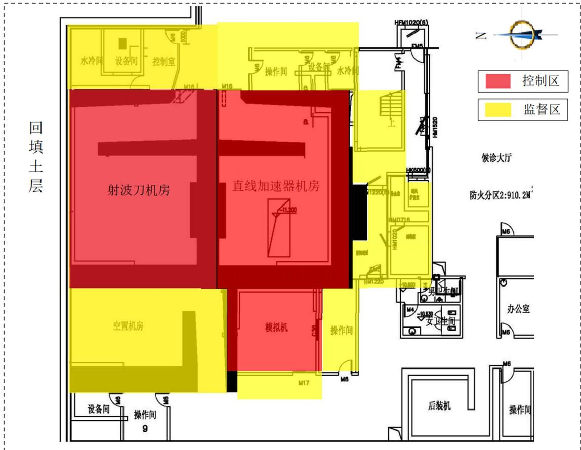
图 2-4 门诊综合楼负二楼 X 射线立体定位放射治疗系统治疗室平面布置图及分区管理
